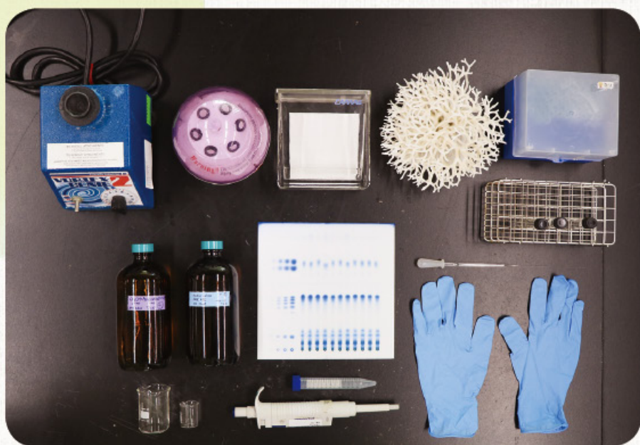
珊瑚共生藻研究器具開箱文：(左上方起)依序為試管震盪儀、微量離心機、玻璃展片槽、珊瑚骨骼、微量吸管尖盒、褐色有機溶劑瓶、薄層層析板、滴管、試管架、燒杯、試管與微量吸管、無粉手套。
