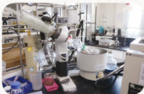
減壓濃縮機：降低大氣壓力至接近真空狀態，以排除實驗過程中的有機溶劑。
